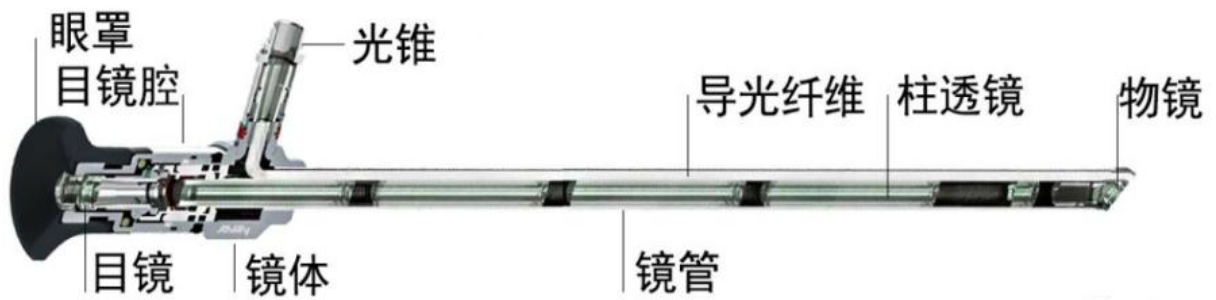
图 3-14 硬式内窥镜结构图
